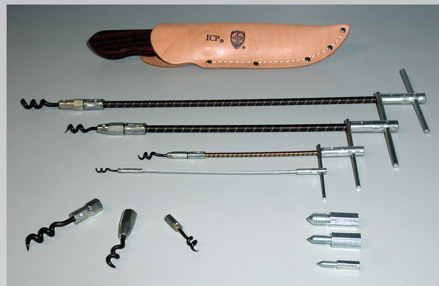
Nástroje pre odstraňovanie a inštaláciu upchávkových tesnení
