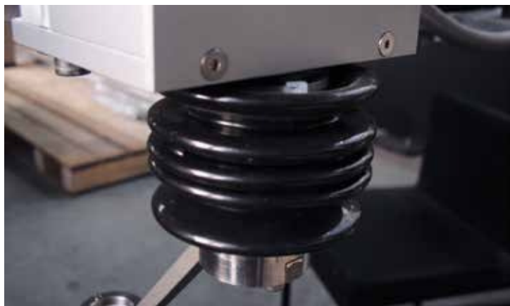
Manžeta Molerit® na hlave rezačieho stroja Materiál: T 59 Typ: 121001-0239
