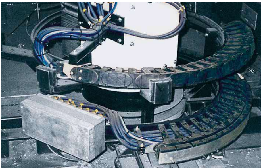
Kombinovaný spirálový a rotační pohyb - igus® twisterchain classic (1. generace)
