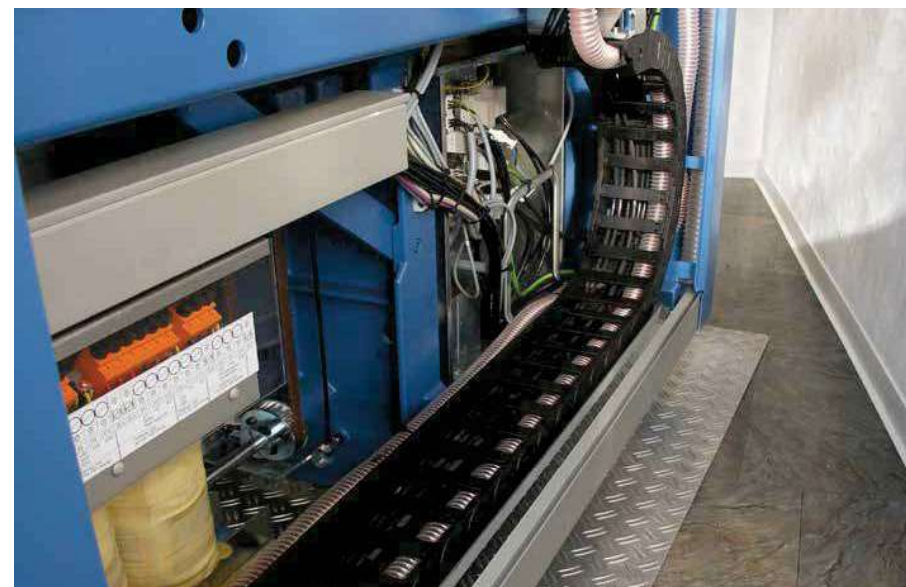
Plochý pletací stroj - systém igus® E2/000 je spolehlivý i při vysokých zrychleních a milionech cyklů
