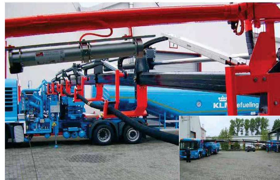
Řada E2/000 série 1400 v aplikaci na tankovací cisterně pro letadla - teleskopický jeřáb se šesti sekcemi
