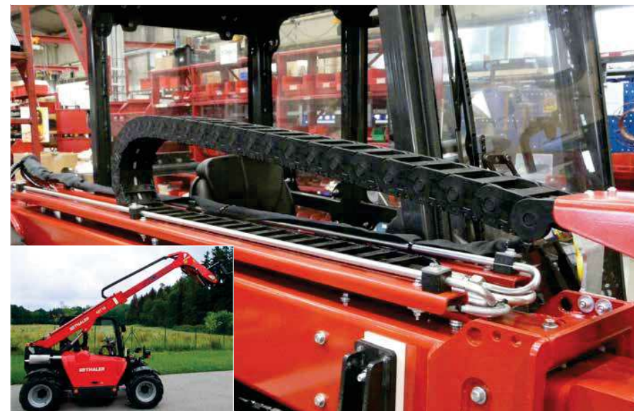
Teleskopický nakladač - řetěz E2/000 e-chain® vede hydraulické hadice přes teleskopické rameno k předvápnému zařízení
