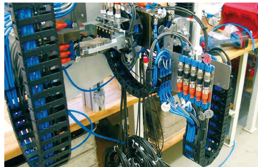
E2/000 - řetěz e-chain® odolný proti znečištění, který šetří instalační prostor - zde v obráběcím stroji
