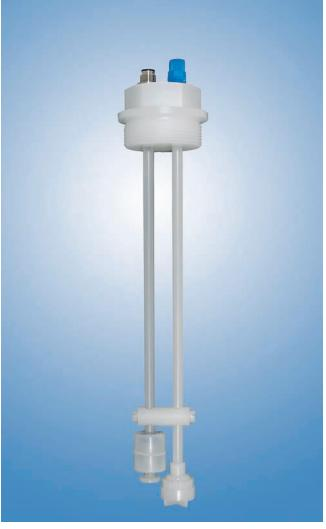
Diese Sauglanze besteht aus einem kompakten Schwimmerschalter mit separat geführter Saugleitung. Der elektrische Anschluss erfolgt über einen M12-Steckverbinder oder über eine Leitung in PVC oder Silikon in gewünschter Länge.
