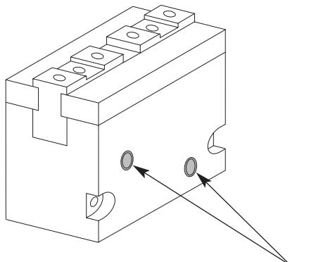
Connessioni pneumatiche filettate standard • Standard threaded pneumatic connections • Standard gewindegeschraubte pneumatische Anschlüsse • Connexions pneumatiques filetées standard
