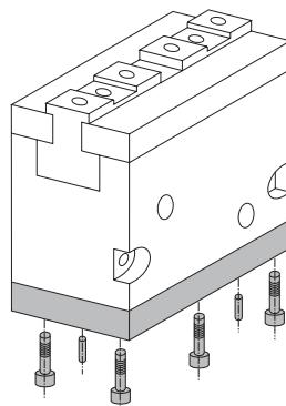
**Montaggio assiale - Fissaggio da sotto**
