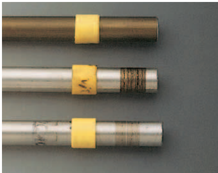
Obrázek 10: Testy opotřebení s hliníkovými hřídelmi
