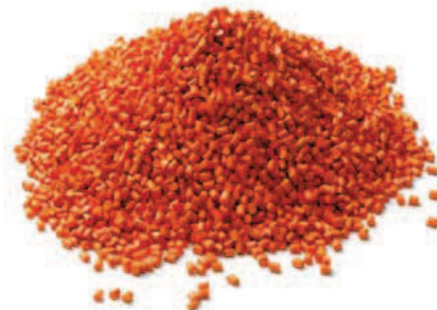
Obrázek 05: Plastový granulát, základ všech samomazných kluzných pouzder iglidur®
