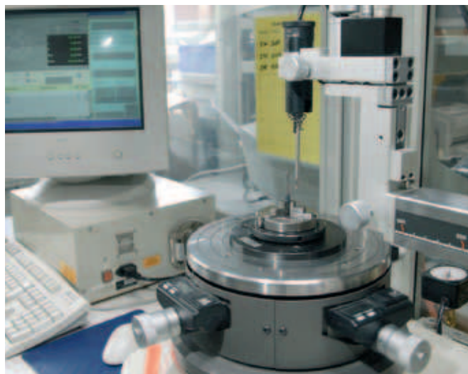
Obrázek 14: Měření vnitřního průměru kluzných pouzder iglidur®
