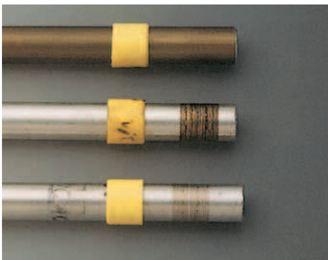
Obrázek 10: Testy opotřebení s hliníkovými hřídelemi
