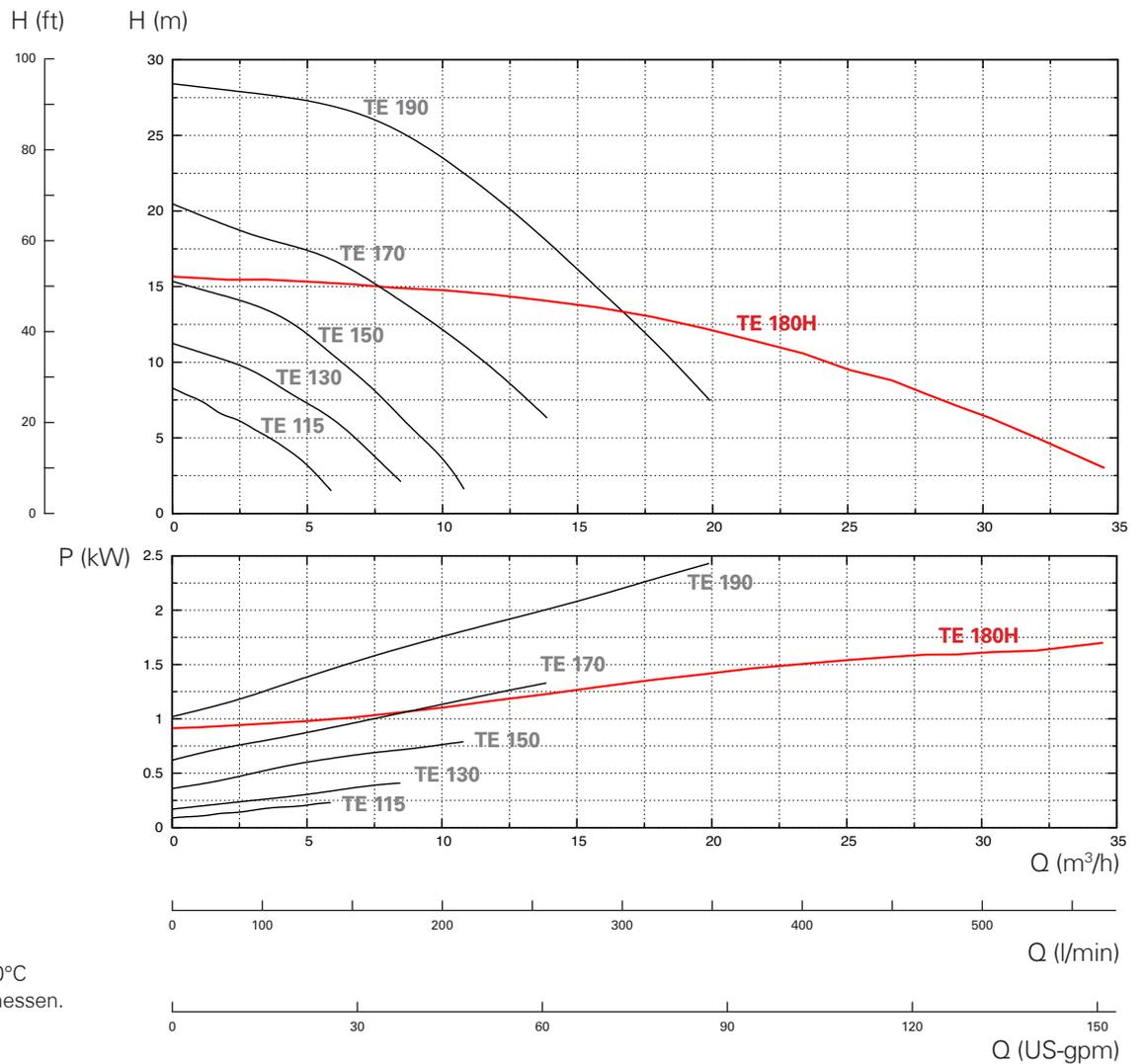
Kennlinien mit Wasser bei 20°C und 2900 U/min (50 Hz) gemessen.
