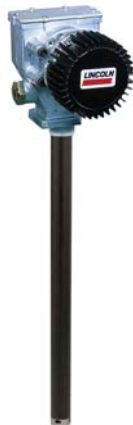
FlowMaster Kolbenpumpe mit 24 VDC Motor Tauchrohr-Ø ~ 32 mm (1-1/4") Pumpenauslass 1/4" NPTF innen
